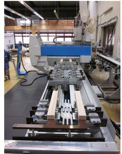
Das Anschlagssystem gewährleistet eine sichere und einfache Positionierung der Einzelteile
