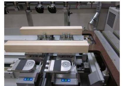
Automatisches Spannen der Teile für stirnseitige Bearbeitung. Patentiertes Spannsystem. Hölzer sind für die Zapf-Schlitz bzw. für die Konterfräsungen mehrfach (je nach Teillelänge) gespannt. Dies gewährleistet höchste Stabilität und damit Qualität!
