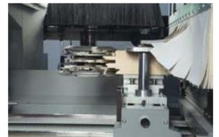
**Dieser Fräsmotor wurde gezielt entwickelt und für die Maschine ausgewählt, um bei geringer Drehzahl den höchsten Leistungsgrad zu erreichen: Eine maßgebende Eigenschaft, die auch bei Einsatz von grossen Werkzeugdurchmessern optimale Resultate garantiert. Die Kombination mit dem Hochleistungsinverter führt zu einer wesentlichen Energieersparnis. Auf Anfrage senden wir Ihnen gerne detaillierte Leistungsangaben zu.**
