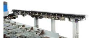
Es können maximal 2 zusätzliche Werkzeugmagazine installiert werden.
