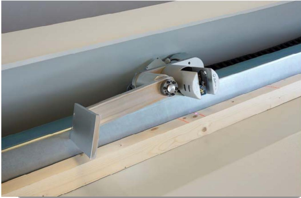
**Total Optic System** ist ein integriertes Einlesesystem, das aus einer Laser-Fotozelle zur Holzerfassung und aus einem speziellen Fluoreszenzsensor zur Zeichenablesung besteht. **Kein manuelles Verstellen bei Holzstärkenänderungen benötigt.**
