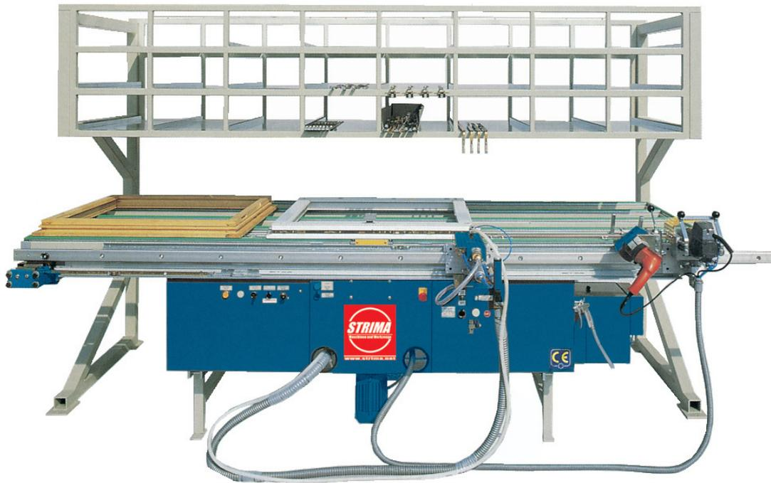
Die STRIMA Beschlag- und Montagestation 2451 ist ein unentbehrlicher Helfer für die Bearbeitung von Fensterflügeln aus Holz und Kunststoff.
