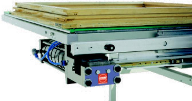
Beschlagstanze zum Ablängen der Beschlagteile. Alternativ kann auch hydropneumatische Stanze angebaut werden.
