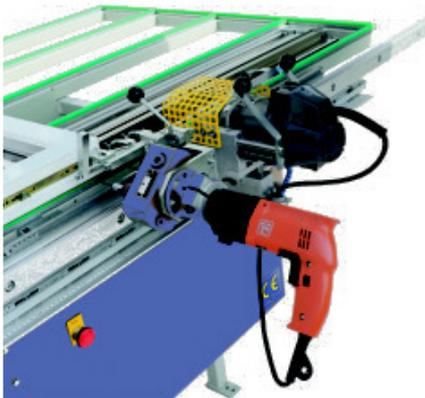
Fräsaggregat mit Mehrspindel- Bohreinheit zum Fräsen von Schlosskästen oder Überschlügen sowie zum Bohren von Beschlagzapfen.
