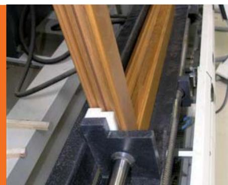
Pressata di una finestra in pre-finito verniciata. Piani teflonati per una migliore scorrevolezza e per la pressata di pezzi già verniciati. Controsagome magnetiche realizzate su specifiche del cliente.
