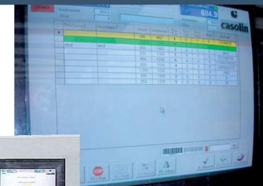
Visualizzazione grafica della commessa di lavoro, gestione pezzi saltati, codice a barre. Collegamento in rete della macchina per la trasmissione dati.
