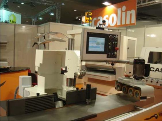
4-Rollen-Vorschubapparat mit motorischer Höhen- / Breitenverstellung und pneumatischer Klemmung
