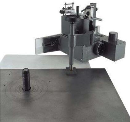
Anschlag komplett wegschwenkbar (z.B. für Rundbogenbearbeitung)
