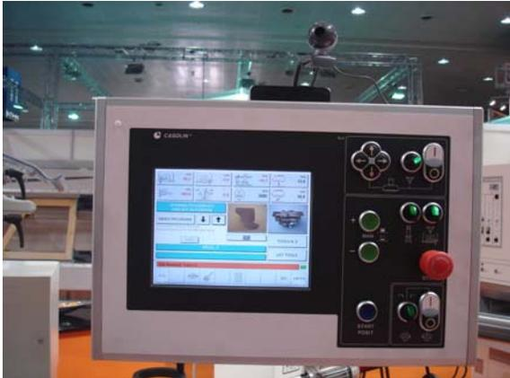
Touchscreen-Steuerung und Kamera für Import von Werkzeug- und Profilzeichnungen
