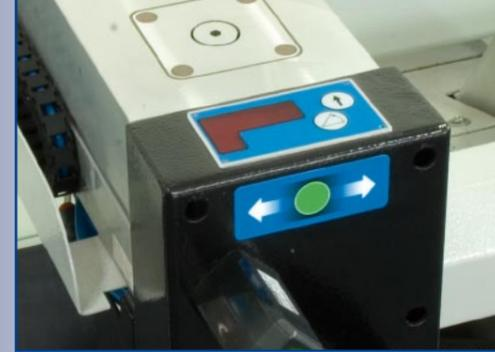
Display digitale per la visualizzazione dei dati, inviati dal CN, per la configurazione del piano macchina in base al programma di lavoro da eseguire.
