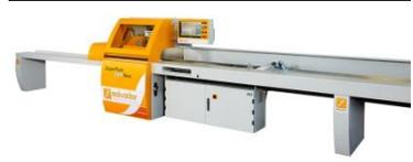
Die numerische Steuerung hat Anschluss an den Computer über zwei Schnittstellen und dient der Holzablesung, Zuschnittkontrolle und eventuell zur Querschnittsabmessung des gesägten Holzes. Die Steuerung ist nach der neuesten Generation konstruiert und ist mit einem Hochleistungsprozessor und Hochleistungsplatinen ausgestattet.
