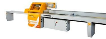
**-Der intelligente Niederhalter:** automatische Anpassung beim Anheben des Niederhalters an diverse Holzstärken des geschnittenen Holzes mit dem daraus folgenden verminderten Niederhalterhub.
