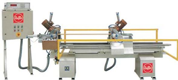
Der Umrüstsatz ist ausgelegt für Striffler Steuerungen EPS 5308 oder EPS PC. (Siehe Abbildung links EPS 5308) Der vorhandene Schaltschrank wird durch den Neuen ersetzt. Die ursprüngliche Verkabelung der Maschine bleibt bestehen und wird im neuen Schaltschrank aufgelegt. Lediglich das Steuerkabel für den mitgelieferten Schrittmotor muss durch den vorhandenen Schutzschlauch gezogen werden. Der Schrittmotor wird mit passender Adapterplatte und Ritzel geliefert.
