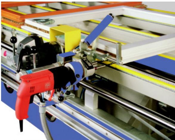
Optionale Ausstattung mit Olivenbohraggregat und abgebildeter Schlosskastenfräse.
