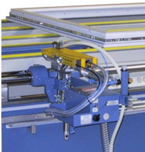
Hochleistungs- Schraubaggregat mit Schraubspindel PVS 81 und angeschlossenem Schraubenzuführgerät UHS 23 und mehrfach Höhenverstellung. Präzise Schraubung durch Tiefenabschaltung.
